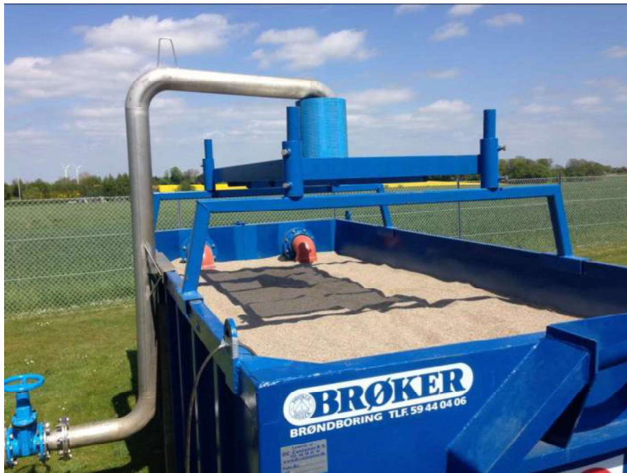
Figur 2. Sedimentationscontainer med iltning og sandfilter.
