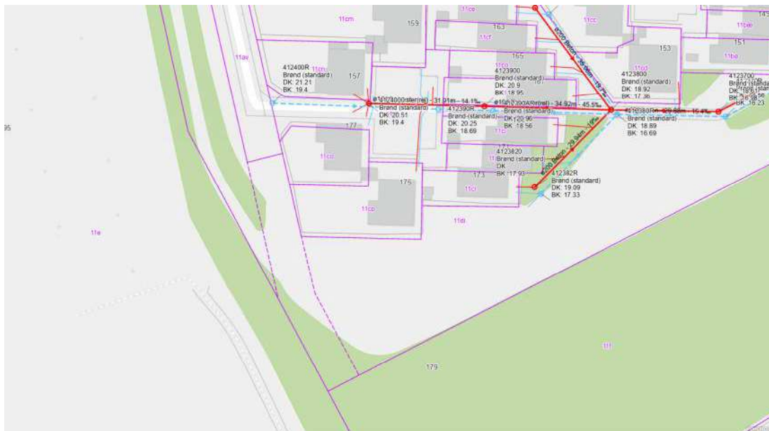
Figur 3: Eksisterende kloak ved Christianshusvej, hvorfra det er muligt at etablere en tilslutning til projektet
